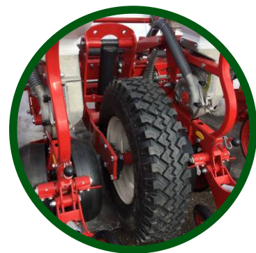
Колёса прицепного устройства
