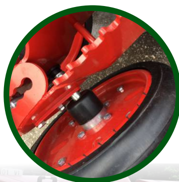
Прикатывающее колесо с дисковым сошником, защищены колпачками
