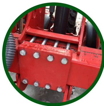
Крепление прицепного колеса
