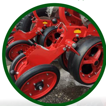
Спидцевые опорные колёса. Подшипник защищён плотной крышкой
