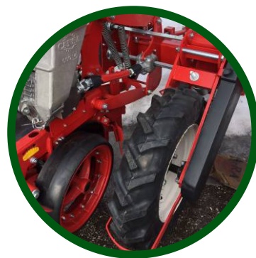
Приводное колесо на высев
