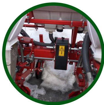
Коробка с передаточным числом на высев, расположена отдельно
